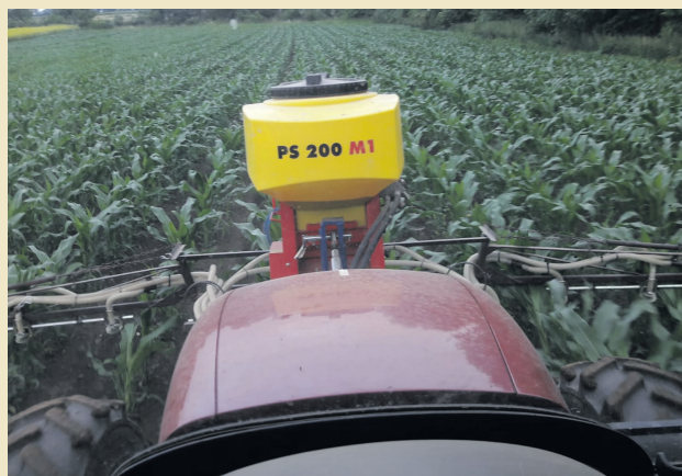
Abb. 3: Untersaatanlage mit Streuer und Schläuchen funktioniert gut.
