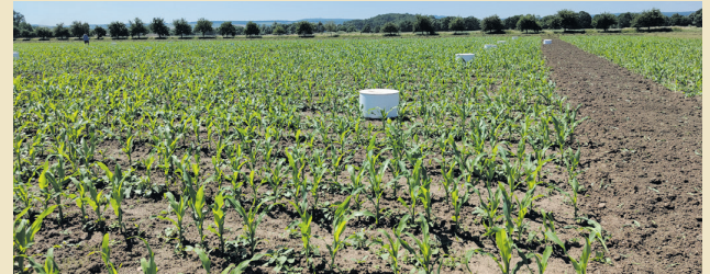
Gasförmige Stickstoffverluste werden mithilfe eines geschlossenen Kammersystems gemessen. F. KHATUN
