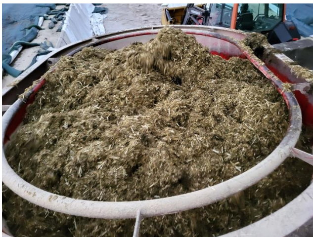
Ab einem Befüllgrad über 90% kommt es vermehrt zum Überlaufen des Futters
