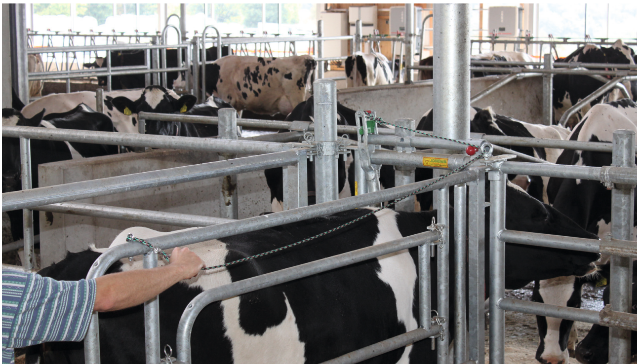
Seilzugvorrichtung zur Fixierung.
